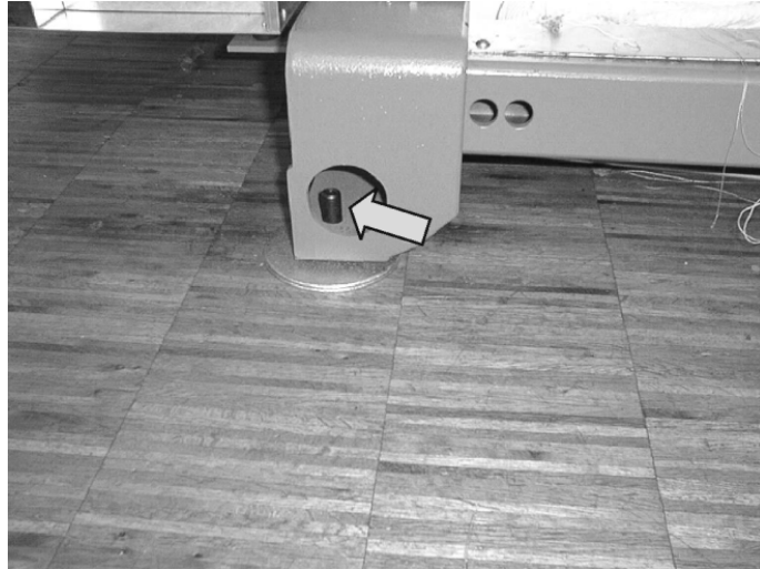
Makinenin ayarlanması için yivli vida
