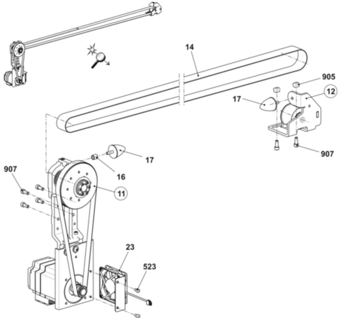
2.1.1 Motor und Riementrieb
