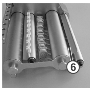
Regolazione della distanza fra la barra di arresto ed il rullo a frizione
