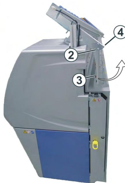
2. Mettre le dispositif de guidage du fil à l'horizontal et resserrer à nouveau les vis (1).
