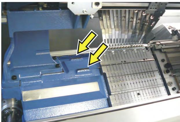
Surface d'appui de gauche pour le niveau à bulle d'air
