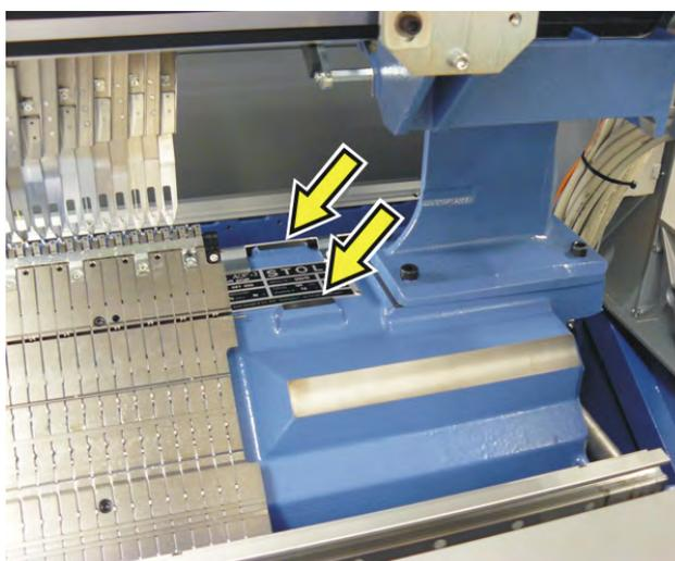
Surface d'appui de droite pour le niveau à bulle
