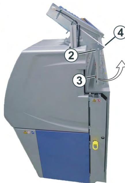
2. Posicionar o sistema de condução de fio horizontalmente e apertar novamente os parafusos (1).
