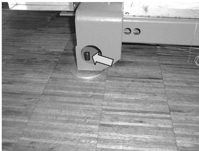
Știfturi filetate pentru alinierea mașinii
