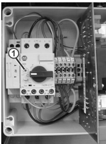
Автоматический выключатель двигателя Q1
