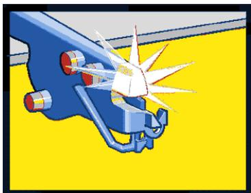
Сигнальная стойка устройства контроля нити
