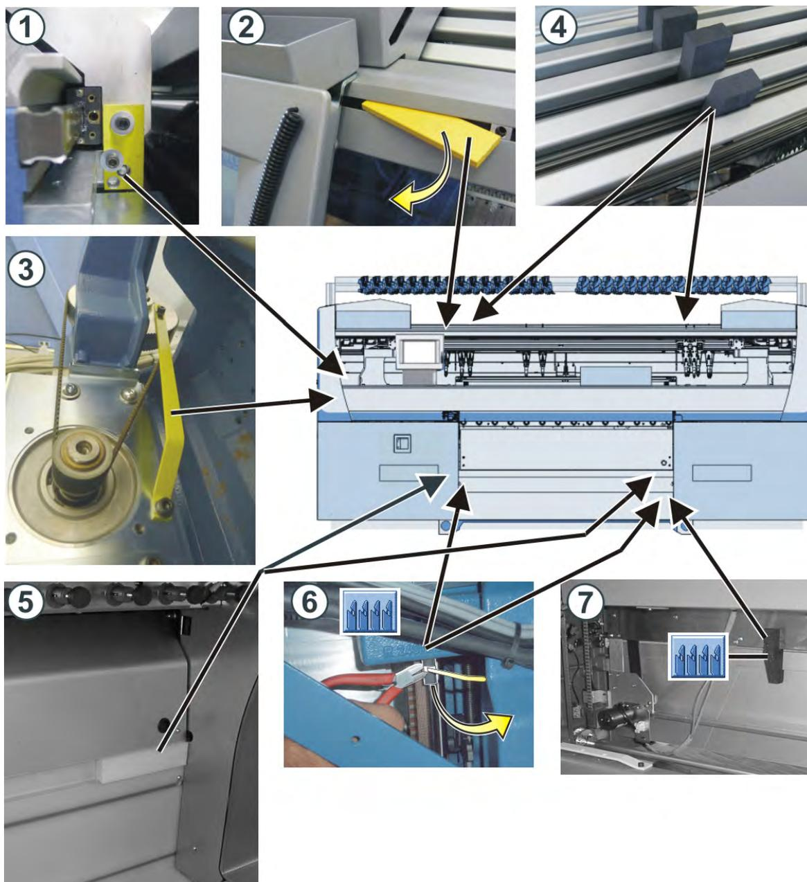
Места установки транспортных фиксаторов
