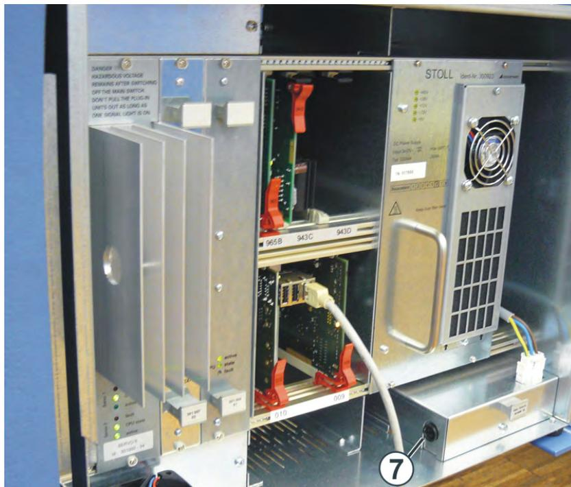
Batteriesicherung unterhalb des Netzgerätes
