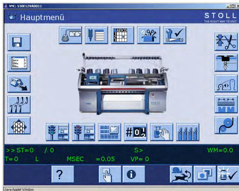
Anzeige der Bedienoberfläche der Maschine im Fenster "Java Applet"
