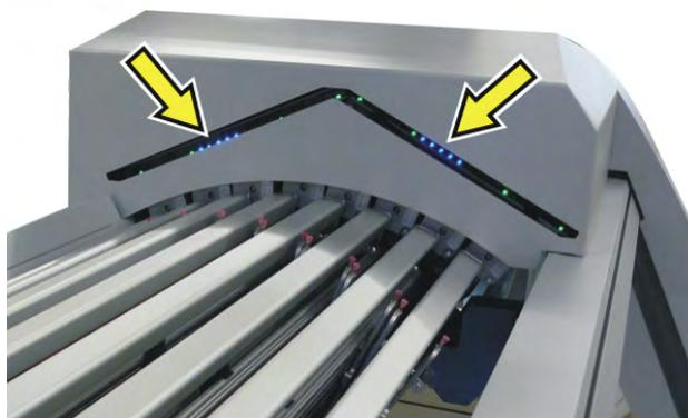
Der Bereich oberhalb der Fadenführerschienen wird durch einen Lichtvorhang überwacht. Der Lichtvorhang erzeugt ein Schutzfeld aus vielen, eng beieinanderliegenden Lichtstrahlen (Abstand: 14 mm). Dringt ein Finger, eine Hand oder ein Gegenstand in dieses Schutzfeld ein, werden der Schlitten und die autarken Fadenführer sofort gestoppt. Am Touch-Screen erscheint ein Piktogramm.
