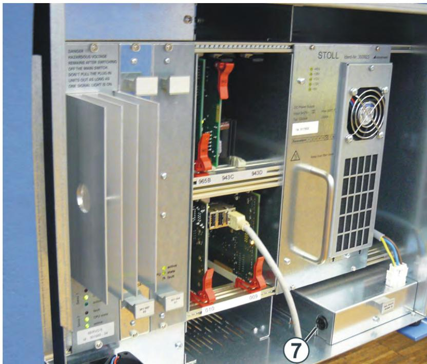
Fusibile della batteria sotto l'alimentatore
