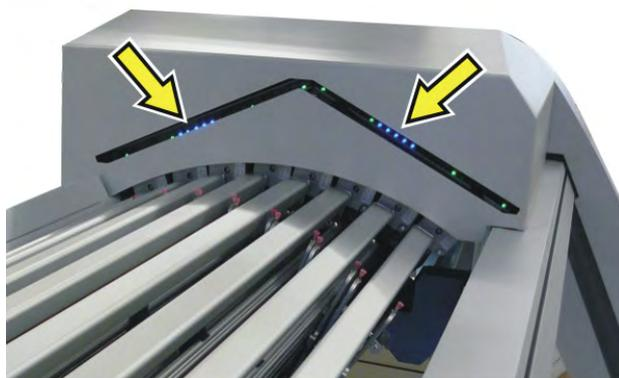
L'area sovrastante le barre del guidafile è sorvegliata da una barriera luminosa. La barriera luminosa genera un campo di protezione costituito da un gran numero di raggi luminosi molto ravvicinati (distanza: 14 mm). Se si introduce un dito, una mano o un oggetto in questo campo di protezione, i carri e i guidafile autonomi arrestano immediatamente. Sullo schermo tattile appare un pittogramma.
