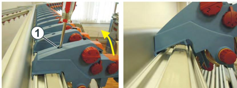
Smontaggio di un dispositivo di controllo del filo
