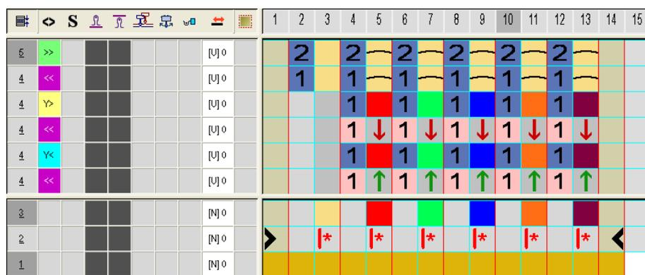
**i** Si en la muestra o en el CA solo se dibuja una acción de la aguja "Hilo flotante" con la necesaria dirección de carro, entonces se entrará automáticamente una dirección autárquica Y< o Y> en el procesamiento.
