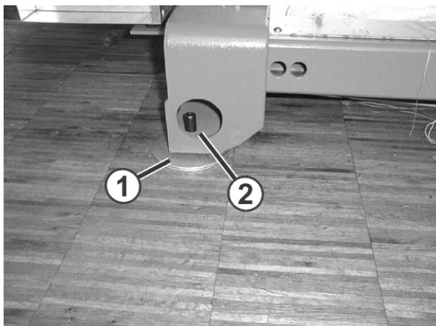
5. Strickmaschine auf den Boden absetzen.
