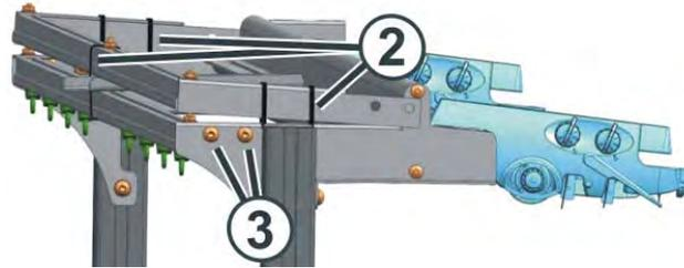
2. Schrauben (3) auf der linken und rechten Maschinenseite entfernen.
