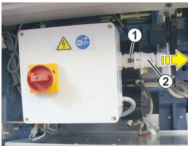
3. Stecker (2) öffnen und an die Netzzuleitung (3a) oder (3b) anschließen.
