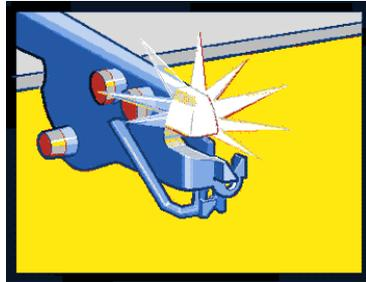
Leuchte an der Fadenkontrollereinrichtung
