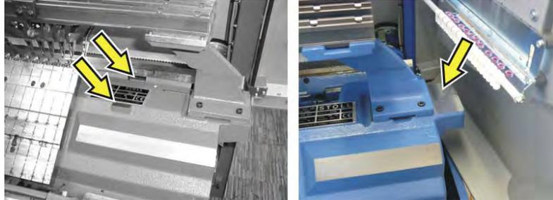
Rechte Auflagefläche für die Wasserwaage (rechts: CMS 502)
