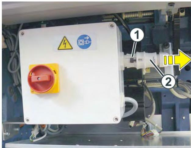
3. Stecker (2) öffnen und an die Netzzuleitung (3) anschließen.
