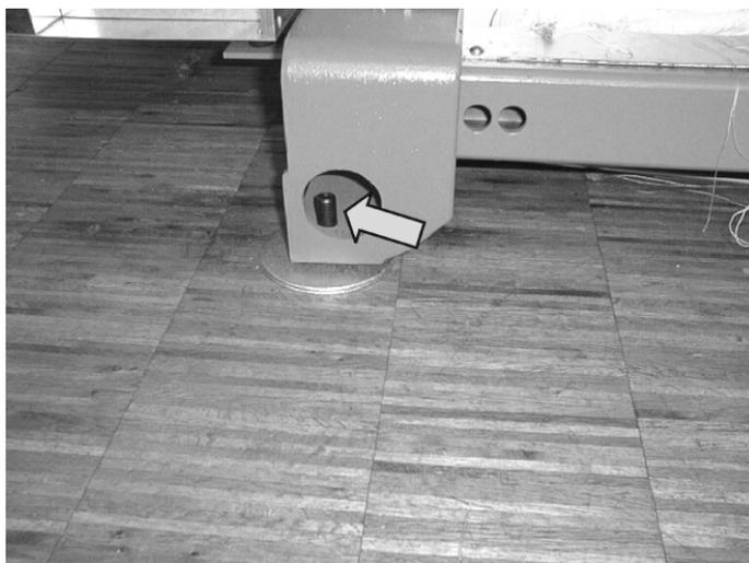
Gewindestifte zum Ausrichten der Maschine
