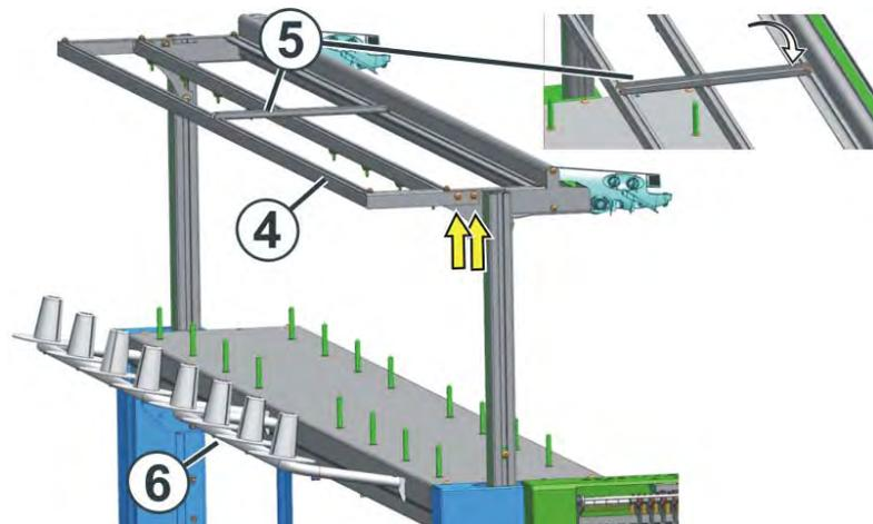
3. Hintere Spur (4) des Fadenleitsystems montieren.
