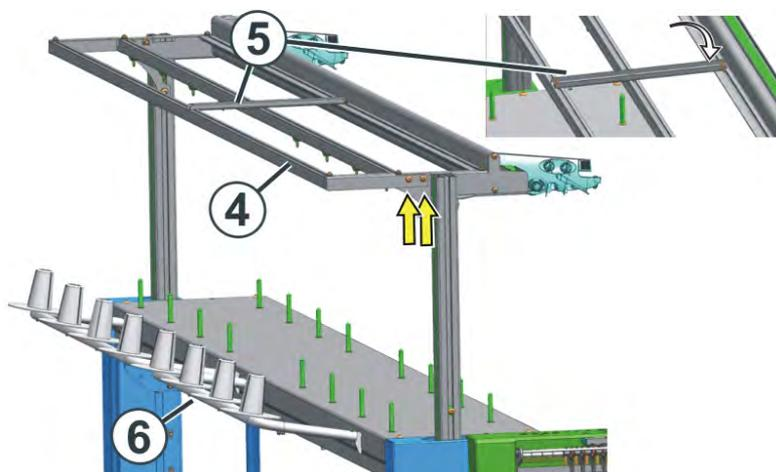
3. Montar la pista posterior (4) del sistema de guía del hilo
