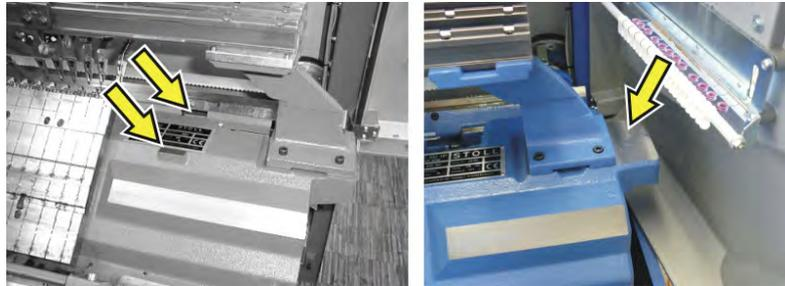
Superficie de apoyo derecha para el nivel de aire (a la derecha: CMS 502)
