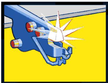
Lámpara en el dispositivo de control del hilo
