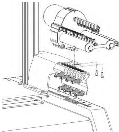
Fijación del alimentador de fricción
