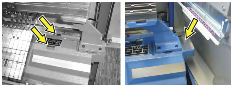
Surface d'appui de droite pour le niveau à bulle (à droite : CMS 502)
