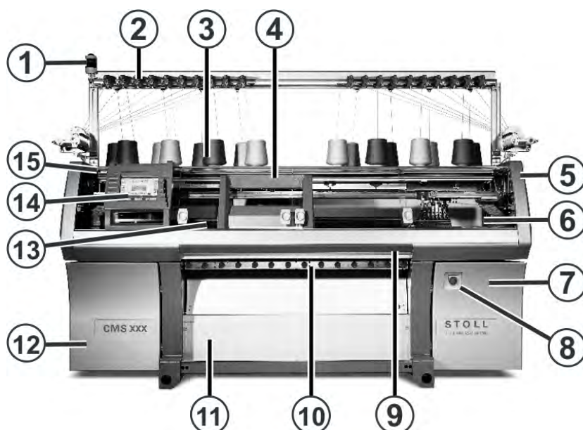
Vista anteriore della macchina per maglieria
