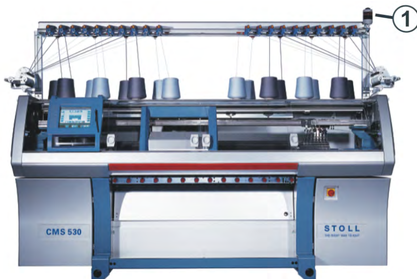
Lâmpada de sinalização do estado da máquina
