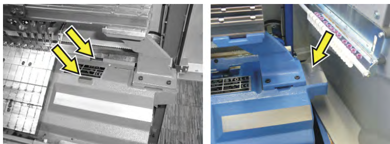
Superfície de apoio para o nível (direita: CMS 502)
