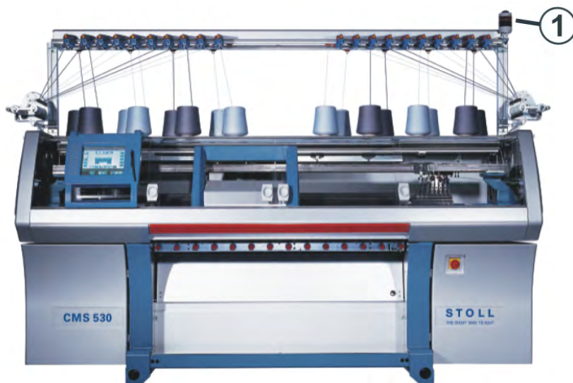
Lâmpada de sinalização do estado da máquina
