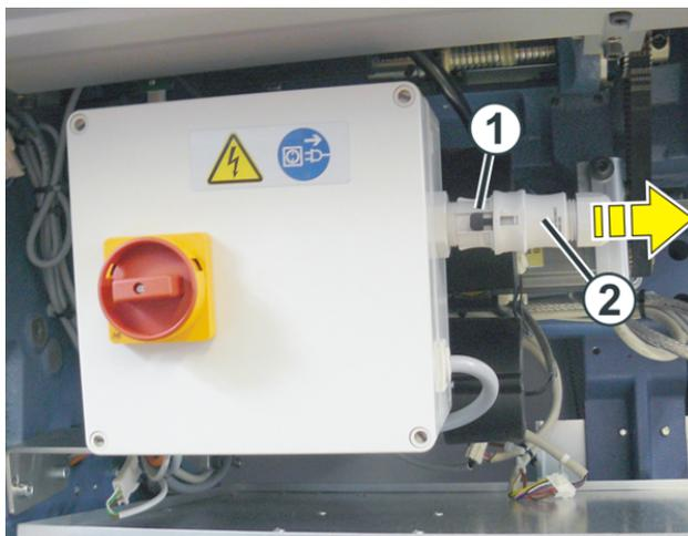
3. Abrir la clavija (2) y conectarla al cable de alimentación de red (3a) o (3b).
