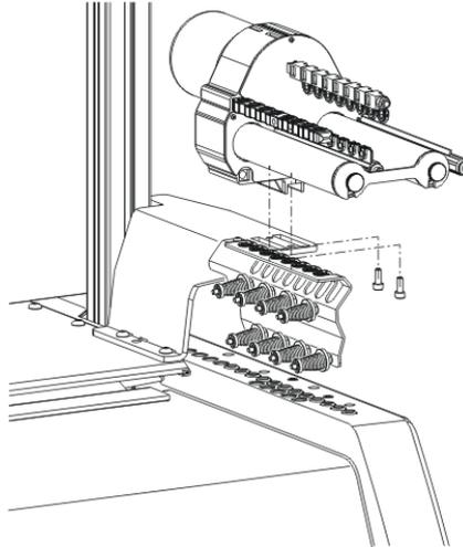
Fijación del alimentador de fricción
