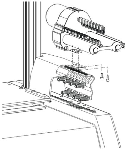
Fissaggio del fornitore a frizione
