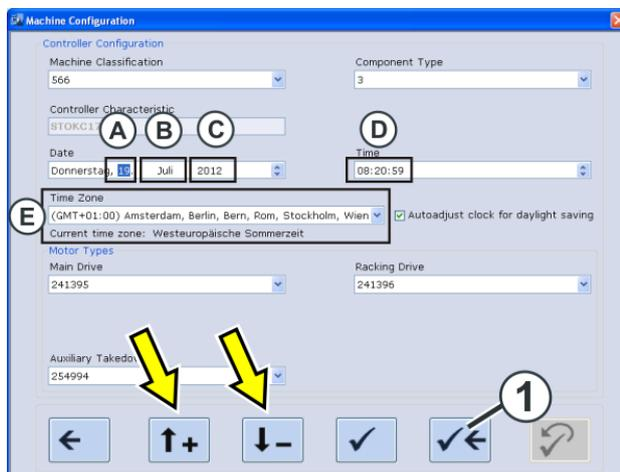
4. Controllare la data (A-C) e l'ora (D). Piccole correzioni dell'ora possono essere eseguite con l'ausilio dei tasti freccia.
