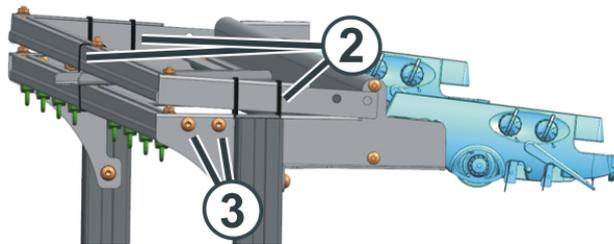
2. Remover os parafusos (3) no lado esquerdo e direito da máquina.
