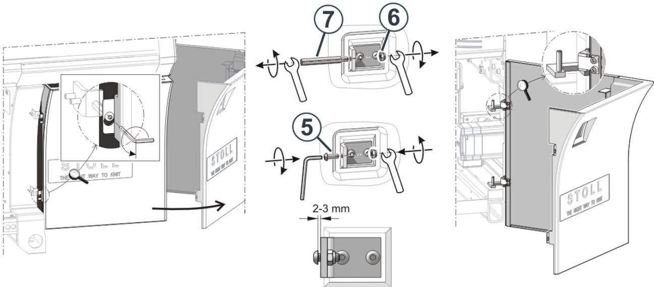
11. Desparafusar a cavilha espaçadora (7).
