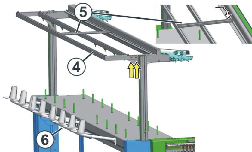
3. Montar o trajeto posterior (4) do sistema de condução do fio.
