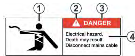
Elemente eines Warnhinweises
