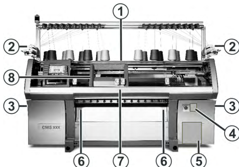
Anbringungsorte der Warnhinweise an der Maschine
