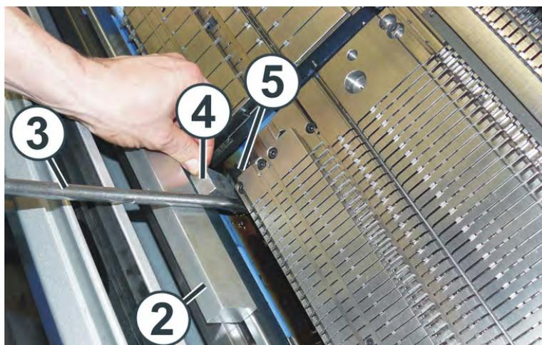
10. 用提手 (3) 将针床抬起一点以便能够将间隔件 (4) 完全置于针床支架 (5) 下。
