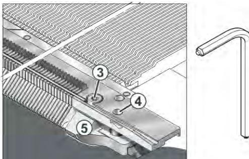
4. 松开沉降片床左右两侧的螺丝 (4)。
