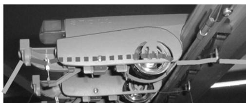
图 47: 纱线控制装置的穿纱路径
