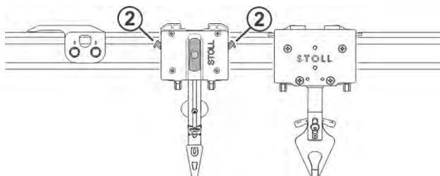
这种新型导纱器没有脱离臂，但却有提升滑杆 (2)，与嵌花导纱器类似。因此，这种导纱器可以与嵌花导纱器一起在同一个导轨上使用。
