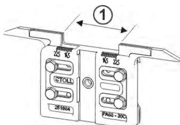
开口宽度 (1) 不同的两个导纱器用来进行普通导纱器添纱。在这种导纱器座上开口宽度可以单独调节的 (23-46 毫米)。
