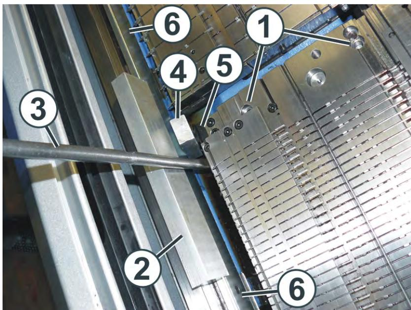
5. 将间隔件 (2) 放到左侧机头导轨上。
