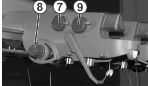
2. 根据纱线粗细和结头情况来调节大结头探测器 (7) 和小结头探测器 (9)，使探测器在遇到一定大小的结头时被触发而停机。
