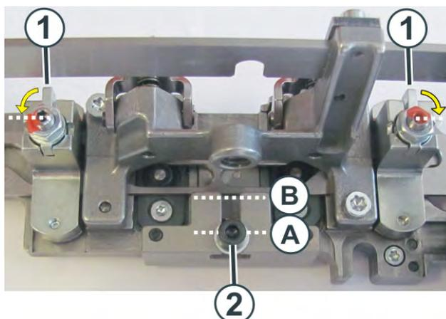
12. 使用内六角扳手移动螺丝，使浮块移动到位置 (B)。
