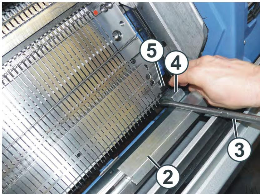
8. 用提手 (3) 将针床抬起一点以便能够将第二个间隔件 (4) 放置到针床支架 (5) 下。
