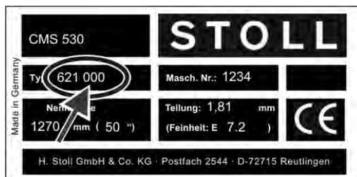
La primera columna de cifras en el campo "Tipo" indica el tipo de máquina y la segunda columna de cifras indica el modelo. En el ejemplo anterior se trata de una máquina del tipo "621", modelo "000".
