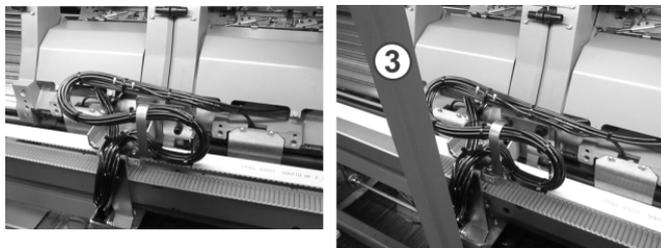
Colocar el tramo de cables en el soporte
