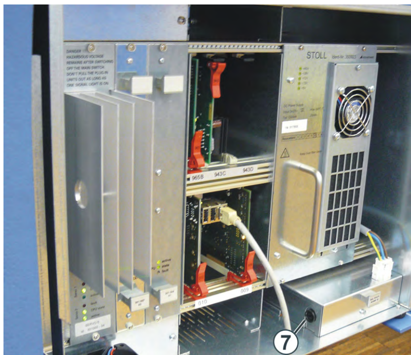
Fusible de la batterie en dessous du bloc d'alimentation
