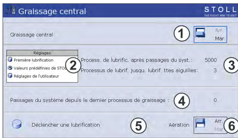
Fenêtre "Lubrification centrale"
