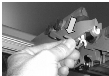
Fig. 47: Chemin du fil dans l'unité de contrôle du fil
