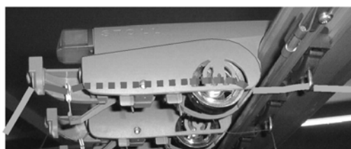
Fig. 51: Percorso del filo nel dispositivo di controllo del filo
