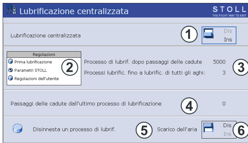
Finestra "Lubrificazione centralizzata"
