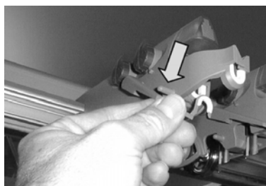
Fig. 51: Percorso del filo nel dispositivo di controllo del filo
