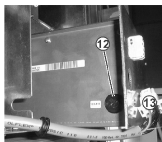
Предохранитель (12) батареи аккумуляторов под блоком питания
