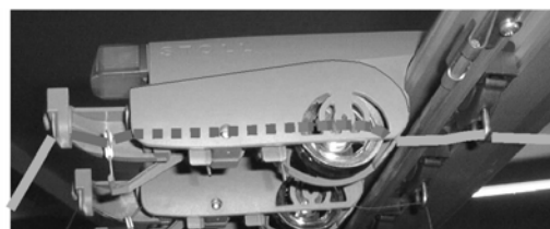
Рис. 51: Заправка нити через устройство контроля нити
