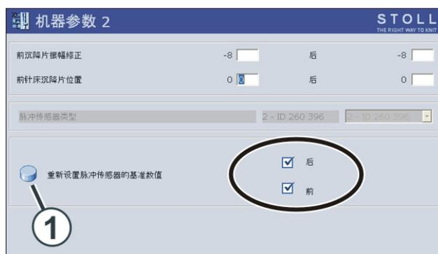
6. 选择所有脉冲传感器 ( 激活控制箱 )。分机头机器有四个脉冲传感器。
