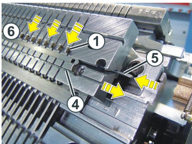
6. 将所有沉降片弹簧 (1) 推到位置 (6) ("打开位置")。
