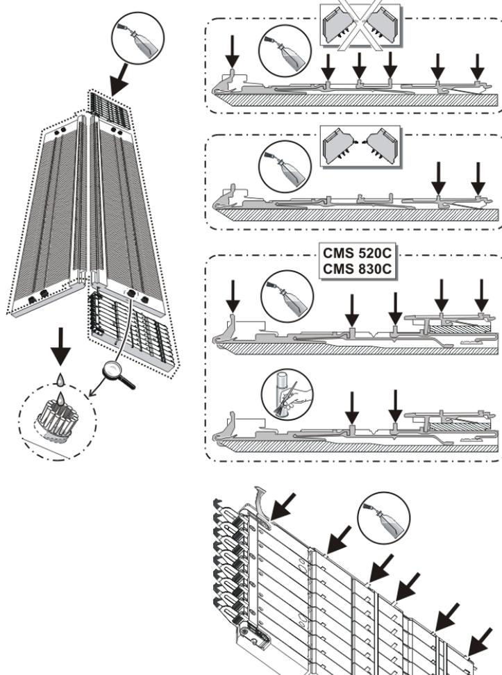
针床加油 (顶部: 无中央润滑装置, 中间: 使用中央润滑装置)
