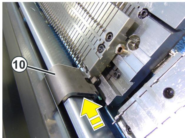
在针床左右两侧，机头导轨护盖上各放一个针床旋转垫块 (10)，向里推动垫块直至顶到沉降片床。
