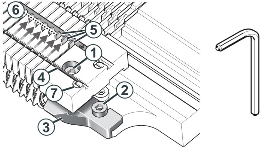
2. 松开沉降片针床左右两侧的螺丝 (1) 和 (2)。可使用随机附件里的特殊六角扳手来拧螺丝 (1)。
