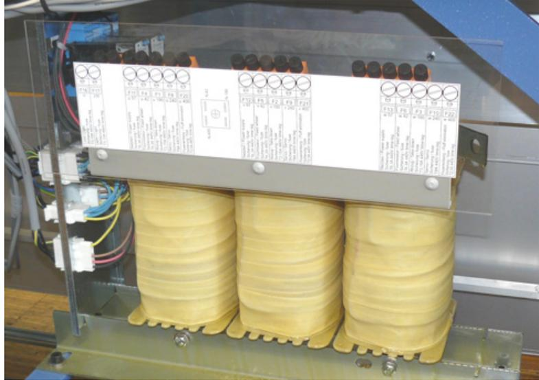
机器后面变压器上的保险管
