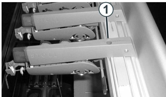
拆卸纱线控制装置
