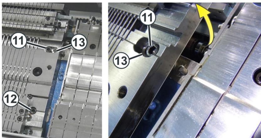
12. 在针床左右两侧，将螺丝 (11) 均匀拧入螺丝孔 (13)。
