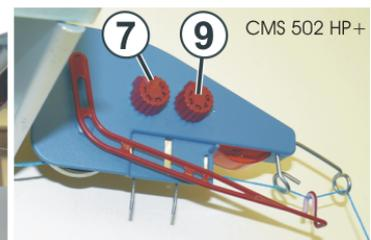
2. 根据纱线粗细和结头情况来调节大结头探测器 (7) 和小结头探测器 (9)，使探测器在遇到一定大小的结头时被触发而停机。
