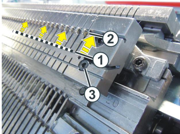
3. 把沉降片床左右两侧的螺丝 (3) 卸下。
