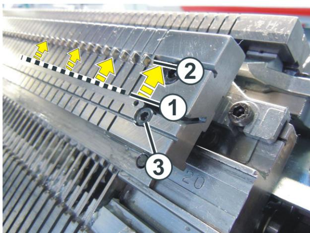
4. 把沉降片床左右两侧的螺丝 (3) 卸下。
