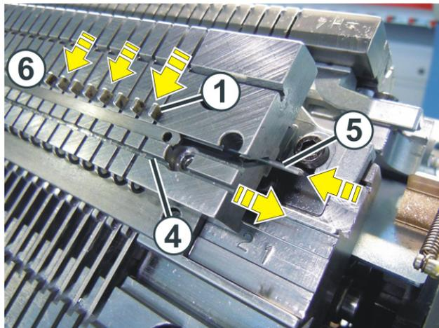
5. 将所有沉降片弹簧 (1) 推到位置 (6) ("打开位置")。
