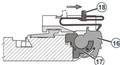
15. 将损坏沉降片的弹簧 (18) 推到 "关闭位置"。
