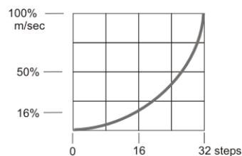
操纵杆半抬时，速度为最终速度的 16%。最终速度将在操纵杆移动路径的下半程获得。
