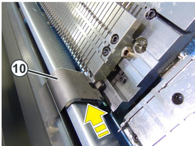
10. 在针床左右两侧，机头导轨护盖上各放一个针床旋转垫块 (10)，向里推动垫块直至顶到沉降片床。
