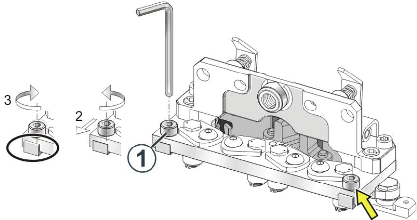
2. 用六角扳手移动螺丝，向下移动浮块。
