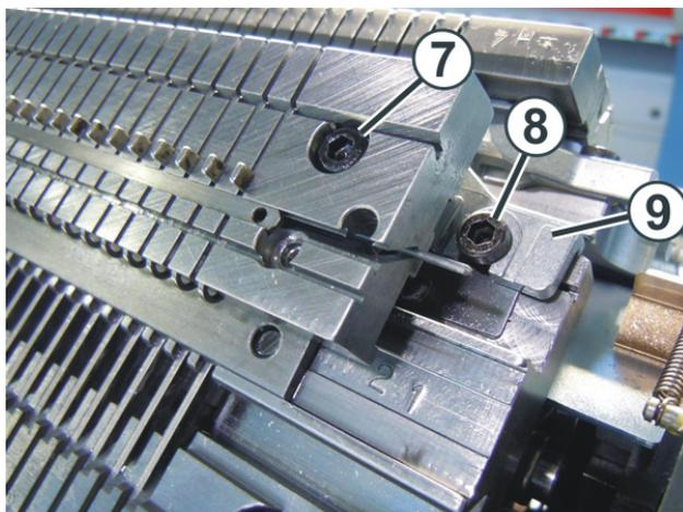
8. 卸下机器左右两侧导纱器限位块 (9)。
