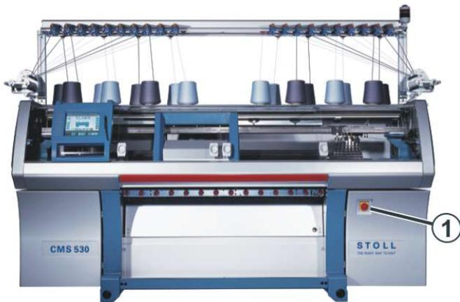
Einrücken der Maschine mit der Einrückstange
