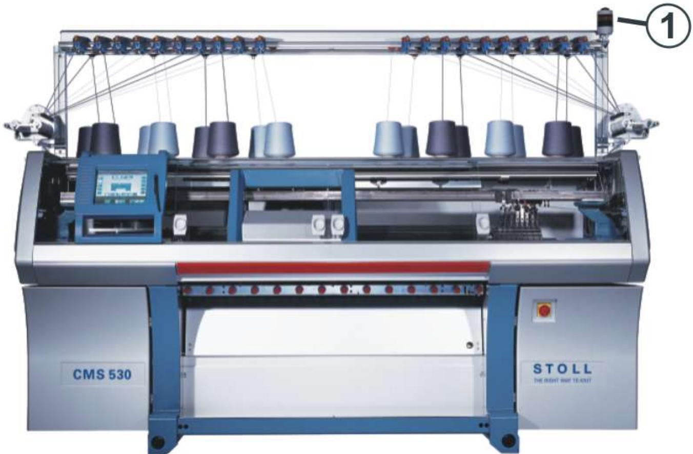
Die zweiflämmige Signalleuchte (1) (grün, gelb) zeigt den Betriebszustand der Strickmaschine an.
