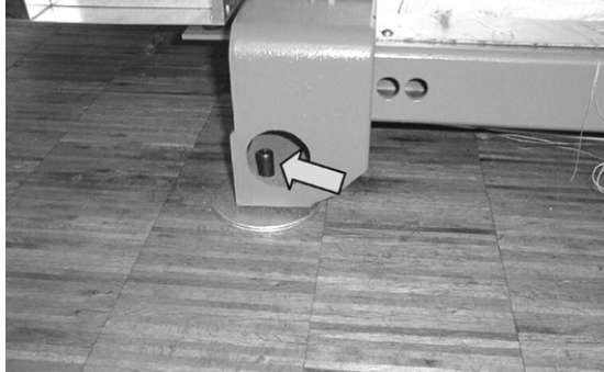
用于调机器水平的调节螺丝
