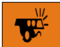
Lampe du dispositif de contrôle du fil
