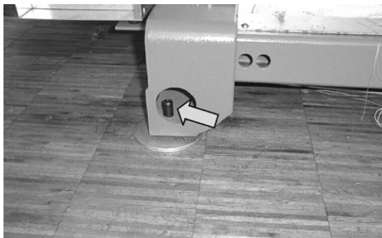
Установочные винты для установки машины по уровню
