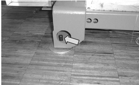
用于调机器水平的调节螺丝
