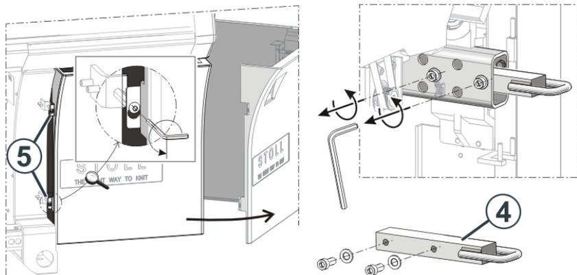
8. Bascular la cubierta del aparato de control hacia afuera.
