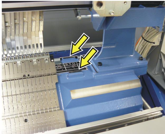
Superficie de apoyo derecha para el nivel de aire
