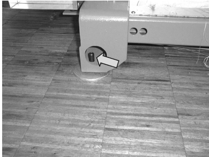
用于调机器水平的调节螺丝
