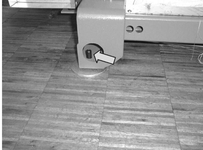
Gewindestifte zum Ausrichten der Maschine
