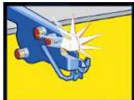
Leuchte an der Fadenkontrolleinrichtung
