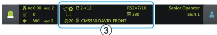
Anzeige bei einem Auftrag aus einem Strickprogramm
