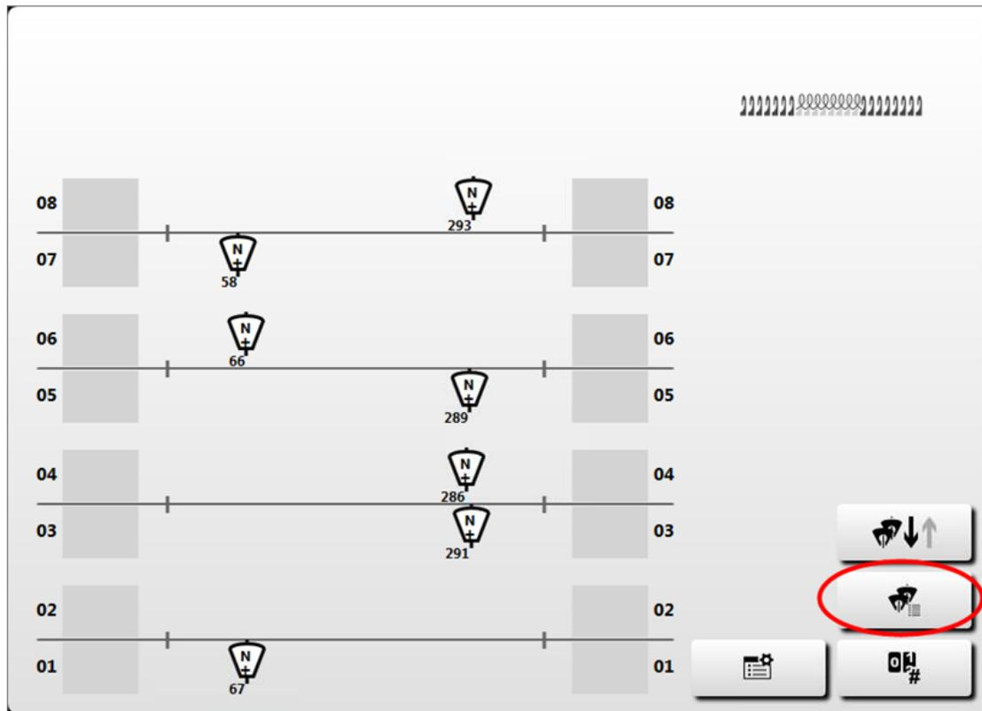
2. Zusätzlich kann auch der Dialog "Fadenführer" mit der Taste
