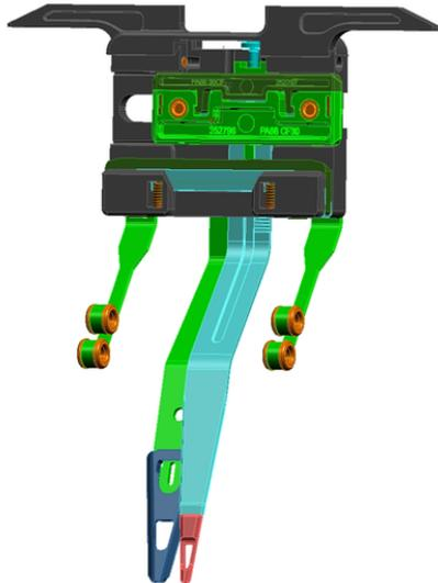
Mit dem Doppelbügel-Fadenführer können Farb- und Qualitätsplattierungen (Elastan) durchgeführt werden.
