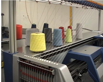
5. Alle Fäden für einen Fadenführer dieser Seite über dieselbe Spur des Rollenumlenkers führen.
