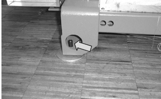
用于调机器水平的调节螺丝
