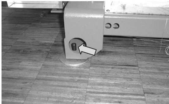
Gewindestifte zum Ausrichten der Maschine
