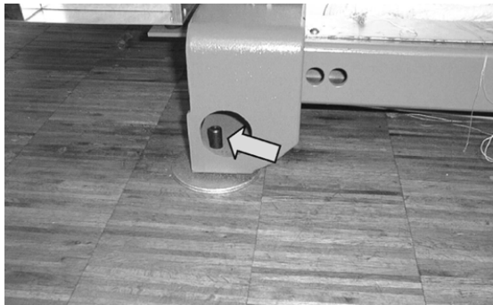
Gwintowane sworznie do poziomowania maszyny
