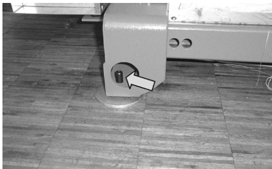
Установочные винты для установки машины по уровню
