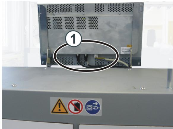
2. Auf der Maschinenrückseite die Rückwand entfernen.
