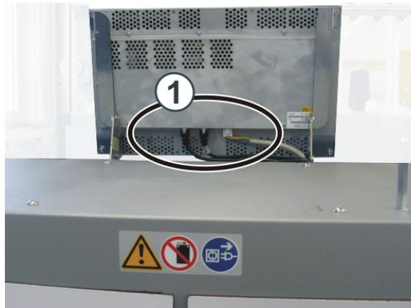
2. Remover a parede posterior no lado posterior da máquina.
