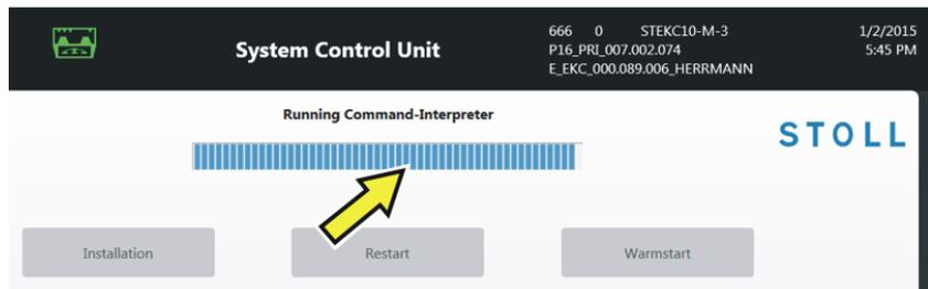
3. Die Steuerung führt automatisch eine Konfiguration aus.
