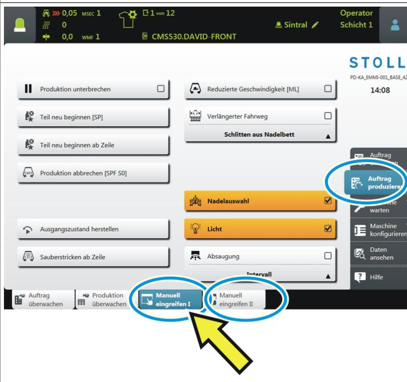
Sind kleinere Tätigkeiten oder Eingriffe notwendig, wechselt der Stricker in das Untermenü "Manuell eingreifen I" oder "Manuell eingreifen II".
