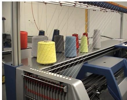
5. 将用于一个导纱器的同侧的所有纱线引过转向杆的同一个轨道。
