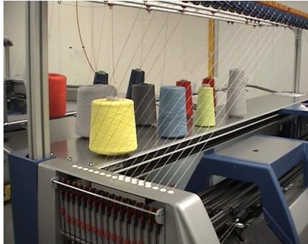
5. Alle Fäden für einen Fadenführer dieser Seite über dieselbe Spur des Fadenumlenkers führen.
