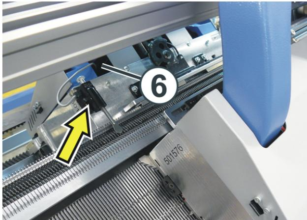
13. 把探针电缆从缝隙（6）引到后侧。
