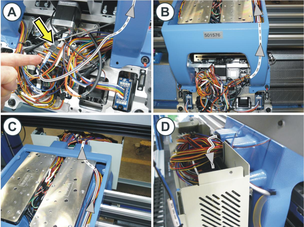
8. 将新电缆 (ID 4170 283 054) 插接到 CN8 插座(3)上。
