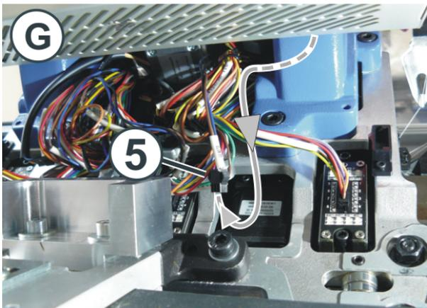
15. 把电缆插接到后探针的插座（5）上（图G）。
