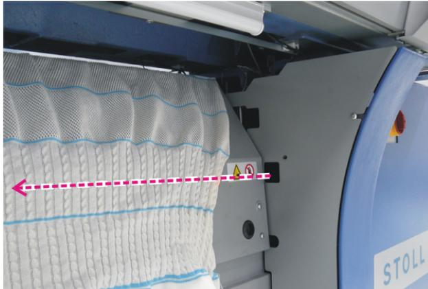
Die Lichtschanke wird mit dem Befehl "LW1" eingeschaltet und mit "LW0" ausgeschaltet.
