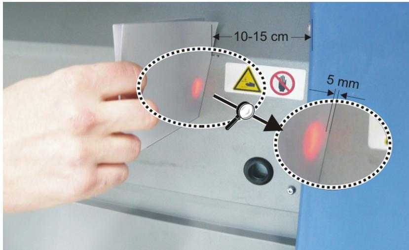
16. Die Einstellung ist korrekt, wenn die äußere Kante des Lichtstrahls ungefähr 5 mm vom Papierrand entfernt ist.
