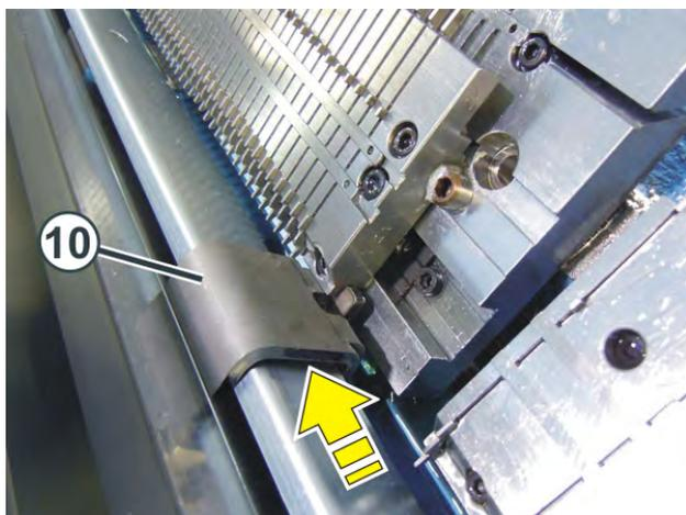
10. Auf der linken und rechten Seite des Nadelbetts eine Nadelbett-Drehstütze (10) auf die Abdeckung des Schlittenführungsstabes aufsetzen und nach innen bis zum Auswahlplatinenbett schieben.
