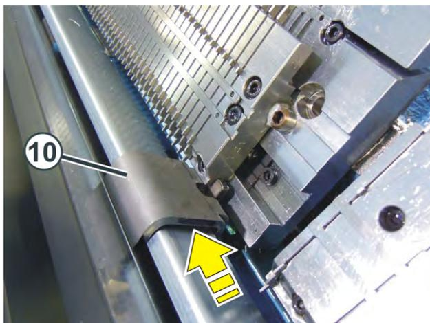
10. En el lado izquierdo y derecho de la fontura apoyar un soporte giratorio de fontura (10) sobre la cubierta de la barra de guía del carro y empujar hacia adentro hasta la fontura de platinas de selección.
