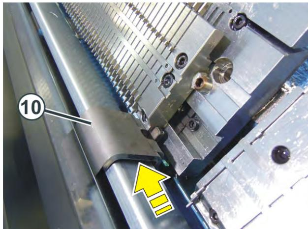
10. Placer un support de fonture pivotant (10) à gauche et à droite de la fonture sur le panneau de la barre de guidage du chariot et le glisser vers l'intérieur jusqu'à la fonture des platines de sélection
