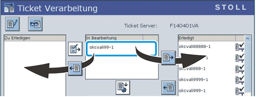
– Ziehen Sie die Einrückstange hoch, wird das nächste Ticket produziert.
